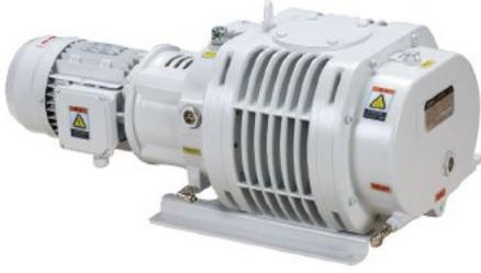
Roots tipi çift rotorlu mekanik vakum pompaları, vakum tesislerinde 1 - 10<sup>-4</sup> Torr (mmHg) aralığındaki basınçları oluşturmak ve korumak için tasarlanmıştır. Bu tip pompaların ana avantajı, küçük boyutlar ve düşük güç tüketimi ile yüksek pompalama hızıdır.
